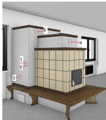
Posizione sonde di rilievo
